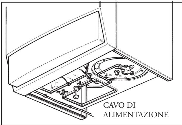
In caso si debba sostituire il fusibile di rete sulla scheda di regolazione, usare un fusibile di 3,15A rapido. Per l'alimentazione generale dell'apparecchio dalla rete elettrica, non è consentito l'uso di adattatori, prese multiple e prolunghe. **N.B.:** se durante l'allacciamento non vengono rispettate le polarità L-N la caldaia non rileva presenza di fiamma ed entra in blocco accensione.
